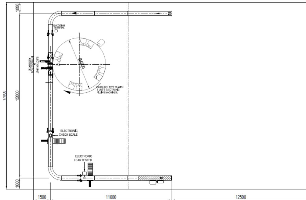
Nota: Esta planta está diseñada para envasar 500 cilindros de 10 Kgs con 7 a 9 Kg/cm<sup>2</sup> de presión diferencial de gas licuado. En general los equipos son ampliables a medida que la planta crezca, destacamos capacidad de la estructura del carrusel para instalar hasta 10 básculas más, además la transportadora se podría extender a todo el perímetro de la plataforma.
